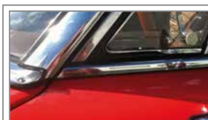
Dettagli parabrezza dalla parte anteriore sinistra, con guarnizione, parti cromate, vernice, luce libera ed eventuale specchietto esterno
